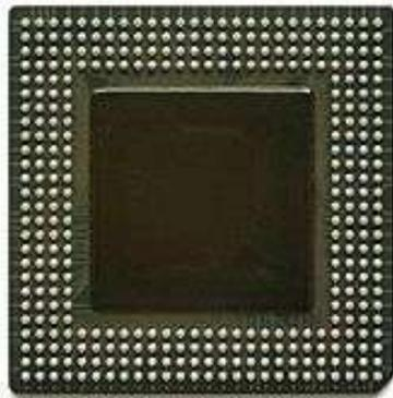
**FIGURE 27: BALL GRID ARRAY**
