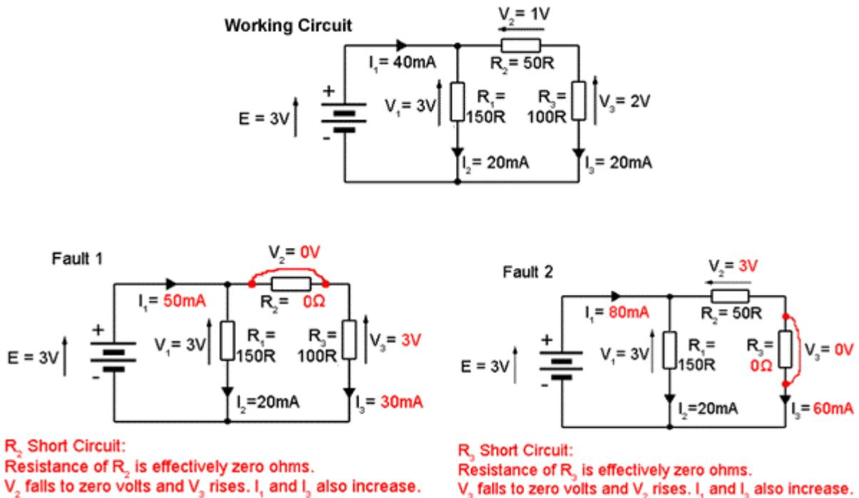
Fig. 4.4.1 Short Circuit Faults
